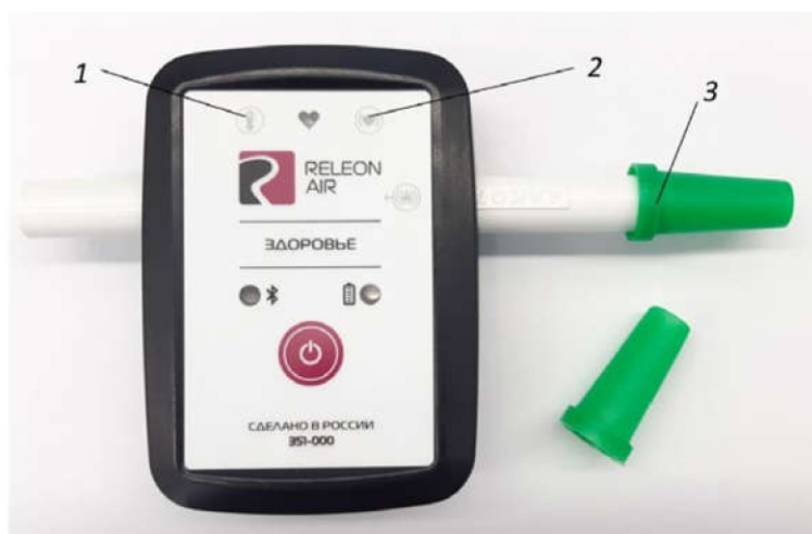
Рис. 3. Мультидатчик по физиологии. Обозначение разъемов и технологических отверстий: 1 — температура тела, 2 — пульс, 3 — частота дыхания (надет съемный мундштук)
